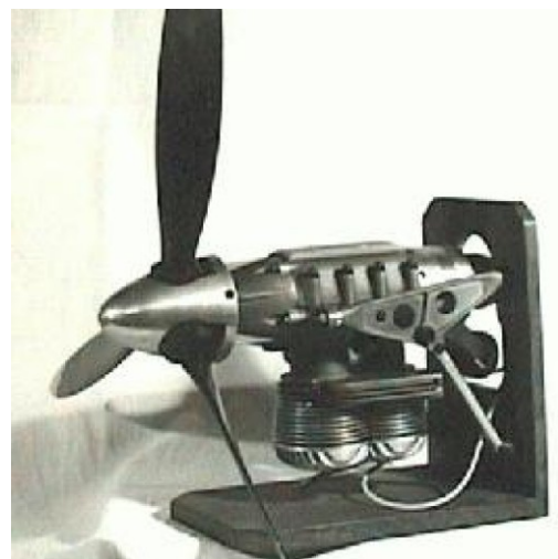
Maquette, moteur essence fonctionnel
