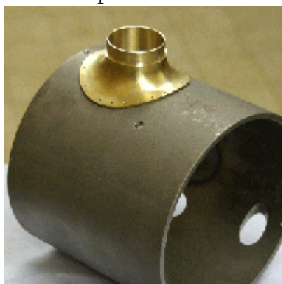
Pièce en position sur la boîte à fumée (chaudière)
